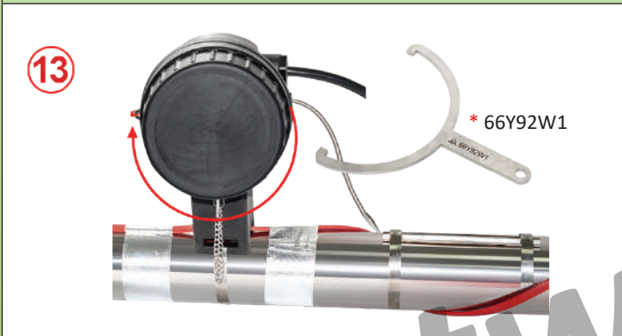
13: Schließe die Leiter gemäß Schaltplan an. Schließe das Stromversorgungskabel an. Schließe den Kontrollkasten.
